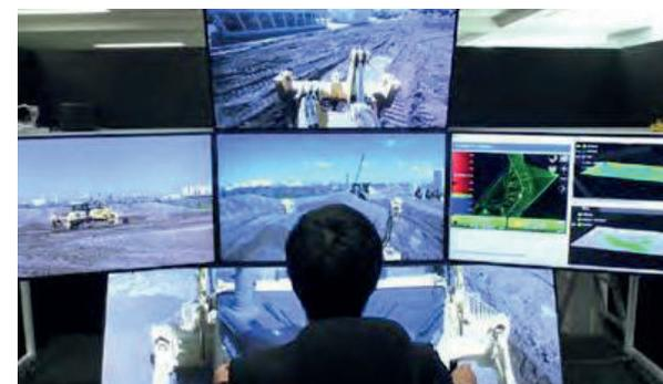
Рисунок 22 — Рабочее место для дистанционного управления экскаватором по сети 5G компании
