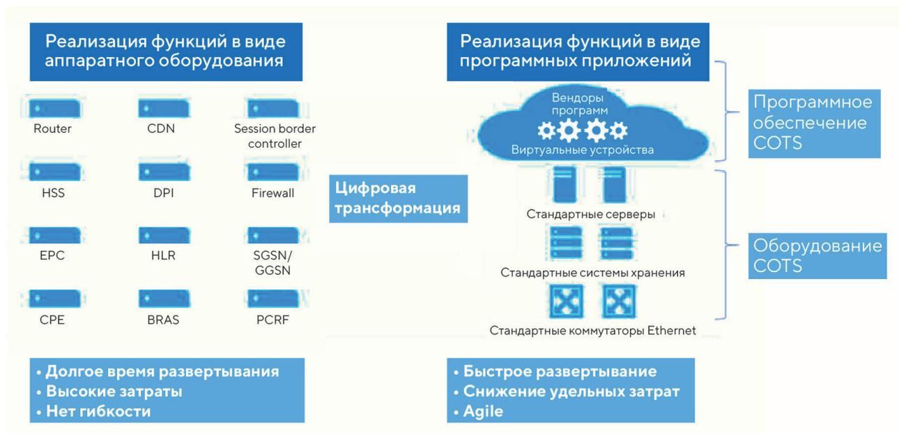
Рисунок 7 – Переход к виртуальной платформе SDN/NFV в 5G
