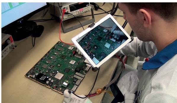
Рисунок 14 — Использование дополненной реальности для проверки микросхем на заводе Ericsson
