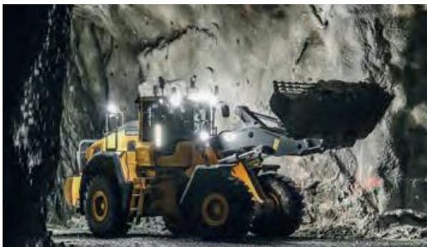
Рисунок 18 — Беспилотный экскаватор Volvo CE, работающий в шахте по сети 5G
